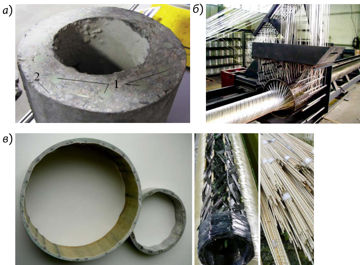
Рис. 2. Опоры с применением композитных материалов а — бетонная опора (1 — стеклопластиковая арматура, 2 — бетон); б — стеклопластиковая опора путем намотки; в — комбинированная стеклопластиковая опора
