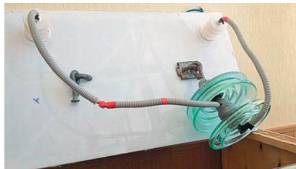
Рис. 5. Крепление изолятора ПС-70Е на испытательном стенде
