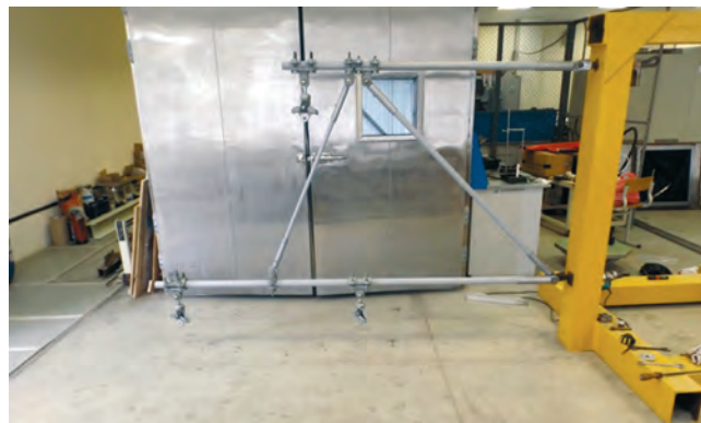
Рис. 4. Кронштейн КПВЛТ, закрепленный на раме
